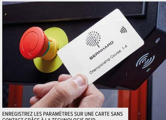
ENREGISTREZ LES PARAMÈTRES SUR UNE CARTE SANS CONTACT GRÂCE À LA TECHNOLOGIE RFID
