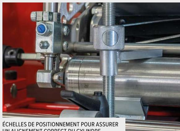
ÉCHELLES DE POSITIONNEMENT POUR ASSURER UN ALIGNEMENT CORRECT DU CYLINDRE
